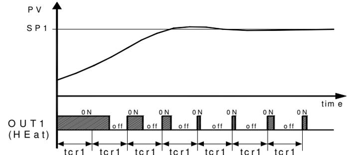
Per ottenere una buona stabilità della variabile in caso di processi veloci, il tempo di ciclo "tcr1" deve avere un valore basso con un intervento molto frequente dell'uscita di regolazione.
