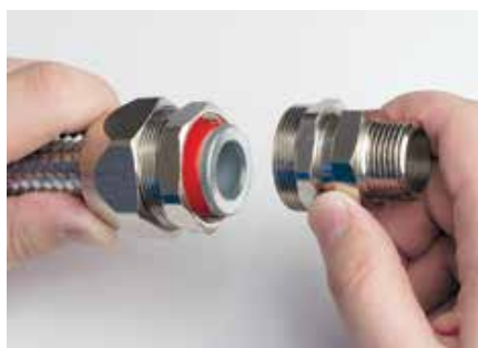
7. Inserire tutti gli elementi nel corpo del raccordo e serrare saldamente il dado (con appositi strumenti) con serraggio idoneo a preservare il grado IP dell'accoppiamento. Se necessario, inserire la guarnizione (piana od O-Ring) sul filetto maschio cilindrico, fino alla battuta.
