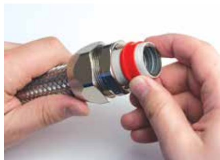
4. Inserire la boccola di bloccaggio in nylon (rossa) con la parte troncoconica rivolta verso il corpo intermedio. Portare il dado di serraggio in battuta sulla boccola.
