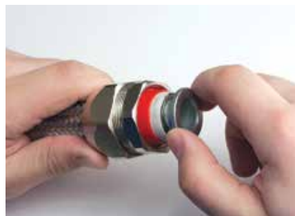
5. Avvitare la virula metallica in senso orario fino al suo arresto.
