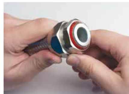
6. Far scorrere la boccola e il corpo intermedio sul tubo metallico fino al contatto tra la boccola e la base della virola.
