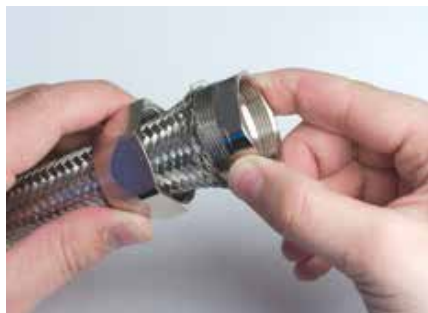
2. Installare il corpo intermedio sotto la treccia, dopo aver rimosso il nastro adesivo. Fissare saldamente il dado e il corpo intermedio insieme, assicurando in tal modo il bloccaggio della treccia.
