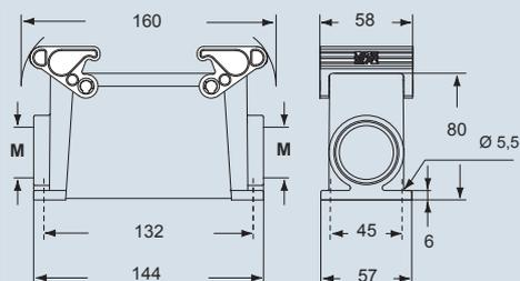
Le custodie fisse da parete, in esecuzione alta, sono fornite con un'uscita già aperta e l'altra uscita, in posizione diametralmente opposta, già filettata ma chiusa, apribile se necessario dall'utilizzatore finale.
