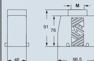
Le custodie fisse da parete, in esecuzione alta, sono fornite con un'uscita già aperta e l'altra uscita, in posizione diametralmente opposta, già filettata ma chiusa, apribile se necessario dall'utilizzatore finale.
