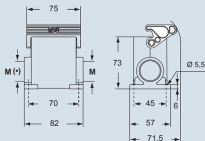
(\*) Le custodie fisse da parete, in esecuzione alta, sono fornite con un'uscita già aperta e l'altra uscita (\*), in posizione diametralmente opposta, già filettata ma chiusa, apribile se necessario dall'utilizzatore finale.
