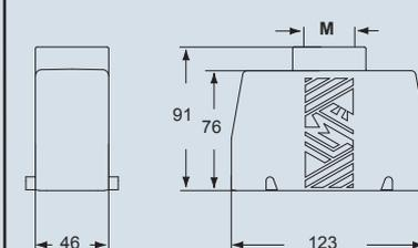
Le custodie fisse da parete, in esecuzione alta, sono fornite con un'uscita già aperta e l'altra uscita, in posizione diametralmente opposta, già filettata ma chiusa, apribile se necessario dall'utilizzatore finale.
