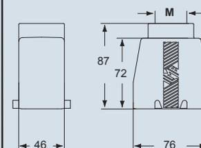
Le custodie fisse da parete, in esecuzione alta, sono fornite con un'uscita già aperta e l'altra uscita, in posizione diametralmente opposta, già filettata ma chiusa, apribile se necessario dall'utilizzatore finale.
