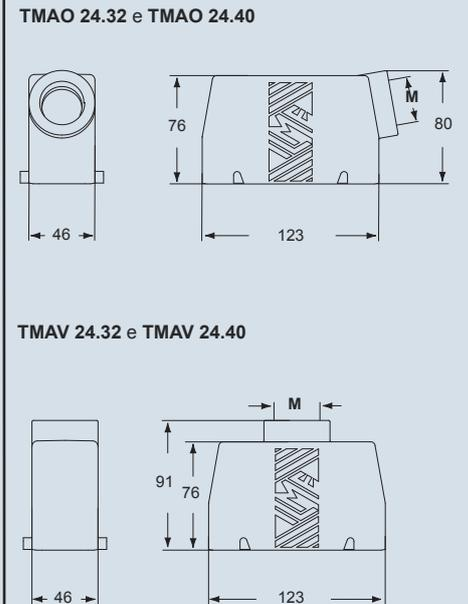
Le custodie fisse da parete, in esecuzione alta, sono fornite con un'uscita già aperta e l'altra uscita, in posizione diametralmente opposta, già filettata ma chiusa, apribile se necessario dall'utilizzatore finale.
