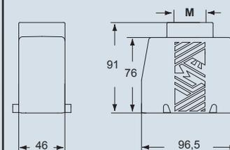
Le custodie fisse da parete, in esecuzione alta, sono fornite con un'uscita già aperta e l'altra uscita, in posizione diametralmente opposta, già filettata ma chiusa, apribile se necessario dall'utilizzatore finale.
