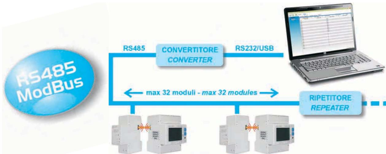
Esempio di applicazione modulo MCIMIDMBU - *MCIMIDMBU module application example*
