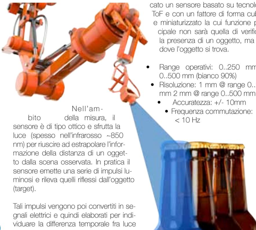
Nell'ambito della misura, il sensore è di tipo ottico e sfrutta la luce (spesso nell'infrarosso ~850 nm) per riuscire ad estrapolare l'informazione della distanza di un oggetto dalla scena osservata. In pratica il sensore emette una serie di impulsi luminosi e rileva quelli riflessi dall'oggetto (target).
