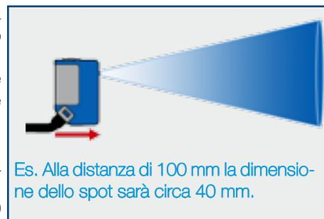
Nonostante il sensore sia di tipo ottico, l'elevata sensibilità del core ToF, permette di misurare anche superfici trasparenti e/o riflettenti. Infatti vengono correttamente rilevati film plastici traslucidi e lastre di vetro (il range operativo dipende dal livello di trasparenza dell'oggetto).
