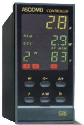
Il regolatore "trim" dell'ossigeno effettua il controllo in continuo del rapporto aria/combustibile, in funzione dell'ossigeno residuo nei fumi combustione e del carico della caldaia.
