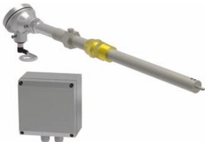
Sonda in-situ all'ossido di zirconio per la misura diretta e continua della percentuale di ossigeno residuo nei fumi di combustione, in **condizioni ambientali gravose** dove alte temperature e/o vibrazioni potrebbero danneggiare l'elettronica a bordo.
