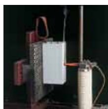
Attrezzatura per prova calore anormale (850°C) GWT.
