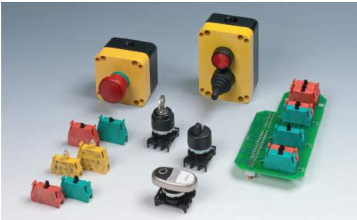
Fissaggio su fori Ø 22,5, grado di protezione IP65, operatori in esecuzione "Black line" o "Nickel line", pulsanti a fungo di emergenza EN ISO 13850, alimentazioni con connessioni a vite, a molla e per circuiti stampati. Pulsantiere complete da 1 a 3 posti, box vuoti da 1 a 6 posti. Esecuzioni per valvole pneumatiche.
