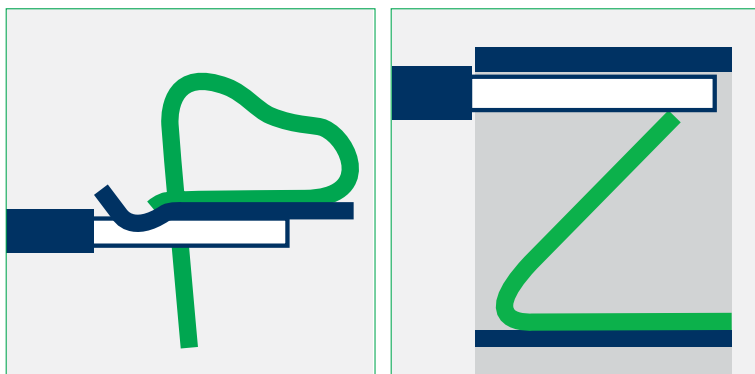
Connessione a molla autobloccante Connessione a molla
