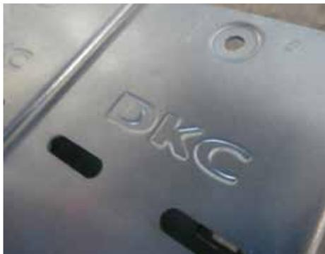
Il nuovo rivestimento ZL presenta molti vantaggi. In caso di bordi tagliati, un sottile film protettivo a base di zinco e magnesio si crea in corrispondenza del taglio e aiuta a prevenire l'insorgenza di reazioni corrosive. Questo film protettivo varia in funzione dell'ambiente di installazione e le sue proprietà dipendono dal contenuto di magnesio.
