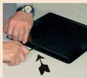
Apertura del coperchio con l'ausilio di un attrezzo. Cover opening by means of a tool.
