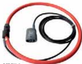
HX72 Captore flessibile AmpFLEX™ Portata: da 5 A a 3500 Aac Banda passante: 200 kHz Diametro di serraggio: 24 cm.
