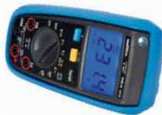
la torcia LED integrata permette di illuminare in punti dove la luce non è sufficiente per realizzare la misura
