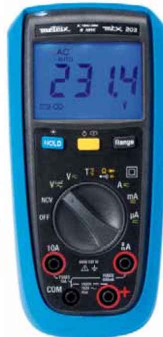
la torcia LED integrata permette di illuminare in punti dove la luce non è sufficiente per realizzare la misura
